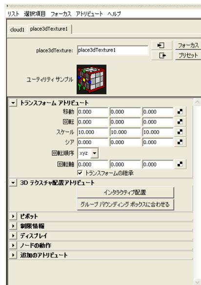
このままでは雲が細かすぎるはずですが、「アトリビュートエディタ」の上のタブから、place3dTexture1 のタブを選びます。トランスフォームアトリビュートのスケールを例えば、10 10 10 と大きくしてみます。(X/Y/Z の順です。)
