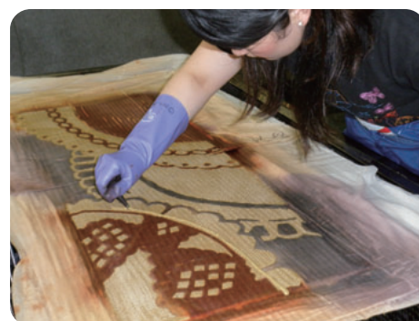
染色実験・注染の作業
