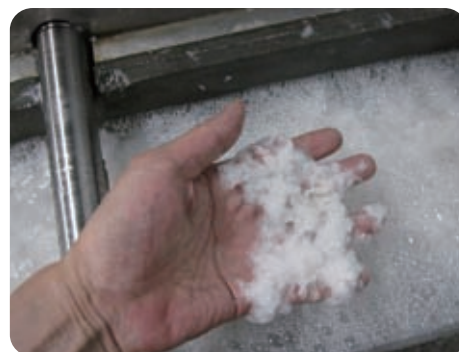
生徒が集めた綿の古布を、大学で繊維化した材料・叩解 60 分後
