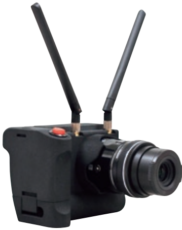
Raspberry Piを使ったIOTカメラ (プロトタイプ OLYMPUS 2018)
