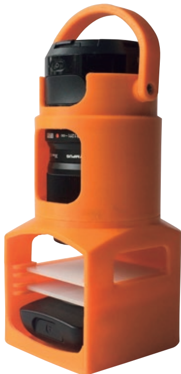
WiFiカメラで簡易デジタル顕微鏡 (プロトタイプ OLYMPUS 2019)
